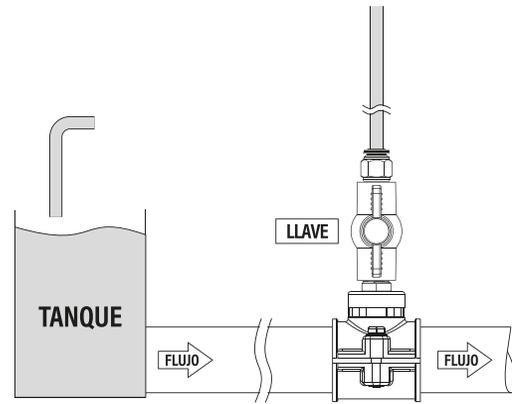
La rosca del sensor es de  $\frac{3}{4}$  NPT, es necesario un collarín con este tipo de rosca y del tamaño de la tubería. En el momento de poner la sonda directamente es importante poner teflón en el sentido contrario de giro de la rosca de la sonda.
