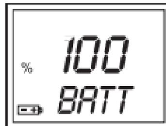
Al encender el equipo, el equipo mostrará en pantalla el porcentaje de batería restante. Cuando el nivel de carga baja por debajo del 5%, el símbolo se iluminará, indicando que pronto será necesario reemplazar la batería.
