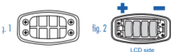
Remueva los 4 tornillos que se encuentran en la parte superior del equipo para acceder al compartimiento de las baterías. Retire las baterías usadas y disponga 4 baterías nuevas prestando atención a la polaridad indicada.
