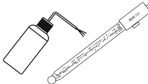
Después de realizar cualquier procedimiento de limpieza enjuague el electrodo con agua destilada y remoje el electrodo en solución de almacenamiento HI 70300 o HI 80300 por lo menos una hora antes de tomar las medidas.
