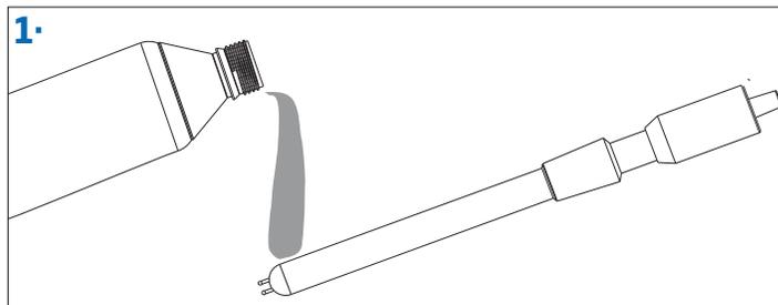
Si se requiere una limpieza más profunda, sumerja el electrodo durante varias horas en la Solución limpiadora de electrodos de pH de uso general HI7061, luego enjuague con agua y luego con metanol. Deje secar antes de reinstalar.
