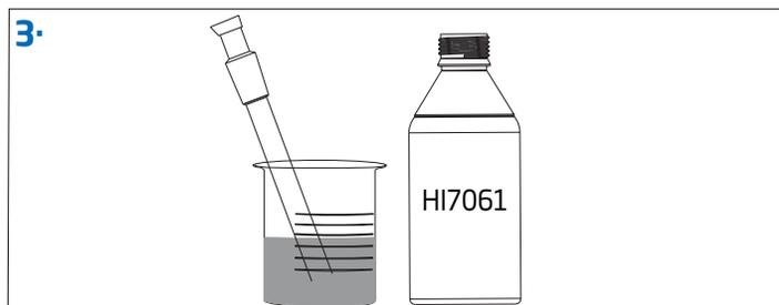
Si se observan estos signos, los pines del electrodo pueden estar sucios. Enjuague el electrodo con un disolvente que sea apropiado para el tipo de muestra utilizada; el metanol suele ser suficiente.
