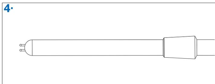
Después de permitir que la sonda se seque, inspeccione el vidrio en busca de grietas, especialmente cerca de los pines del electrodo. Reemplace el electrodo si encuentra grietas.
