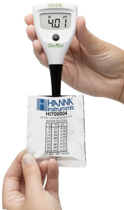
**-Gran pantalla LCD:** Mejora de LCD que muestra la lectura, indicador de estabilidad, la etiqueta de indicador de batería baja y calibración.
